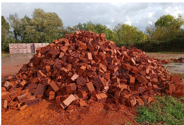
Slika 6. Otpadni proizvodi loše kvalitete u tvornici opeke
