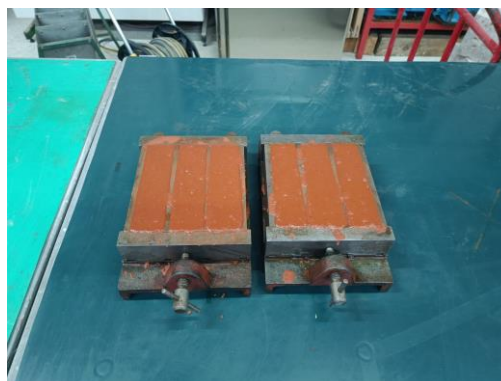
Slika 10. Njega uzoraka geopolimera na sobnoj temperaturi
