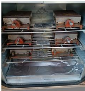
Slika 9. Njega uzoraka geopolimera na povišenoj temperaturi, u sušioniku
